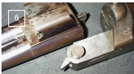
Илл. 9. Двустольное ружьё фабрики Scholberg & Delheid (а) по патенту Ф. Егера с крюками, обхватывающими унитарную подушку (б), один из листов патентной заявки (в) на шарнирное соединение цапфенного типа и статья в журнале «Охотничье оружие» 1911 года (г)
