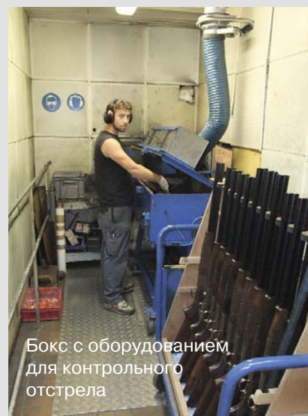
Установка для контрольного отстрела с установленной браунинговской вертикалкой
