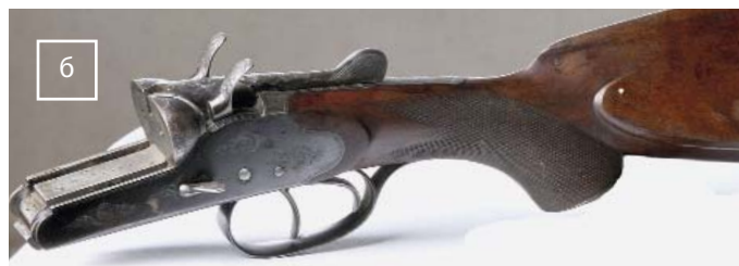
Илл. 7. Двустольное полубескурковое ружьё Г. Биттнера, выпускавшееся под коммерческой маркой Genial-Gewehr. Особенность его конструкции – затворная система на цапфенной подвеске с четырьмя ствольными
