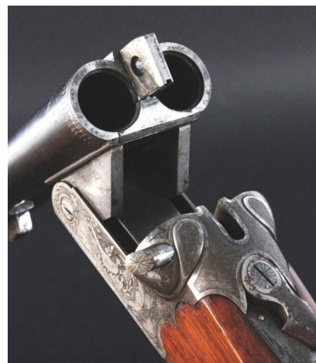
Илл. 15. Двуствольное ружьё германской фабрики Emil Kerner & Sohn (около 1920 года), изготовленное по патенту Ф. Егера
